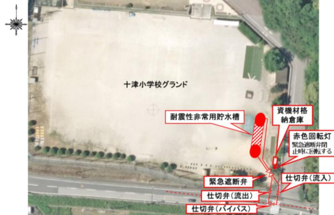
十津小学校耐震性非常用貯水槽配置状況
