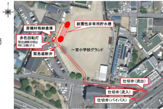
一宮小学校耐震性非常用貯水槽配置状況
