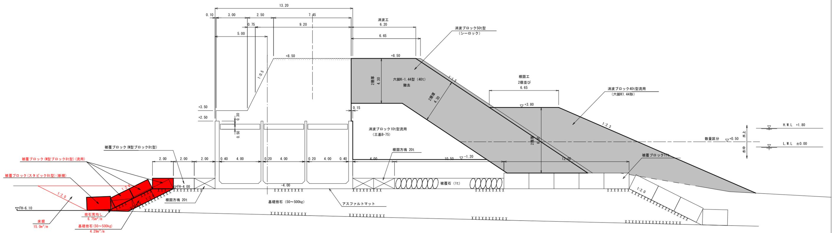
基礎工・撤去工・被覆工詳細図
