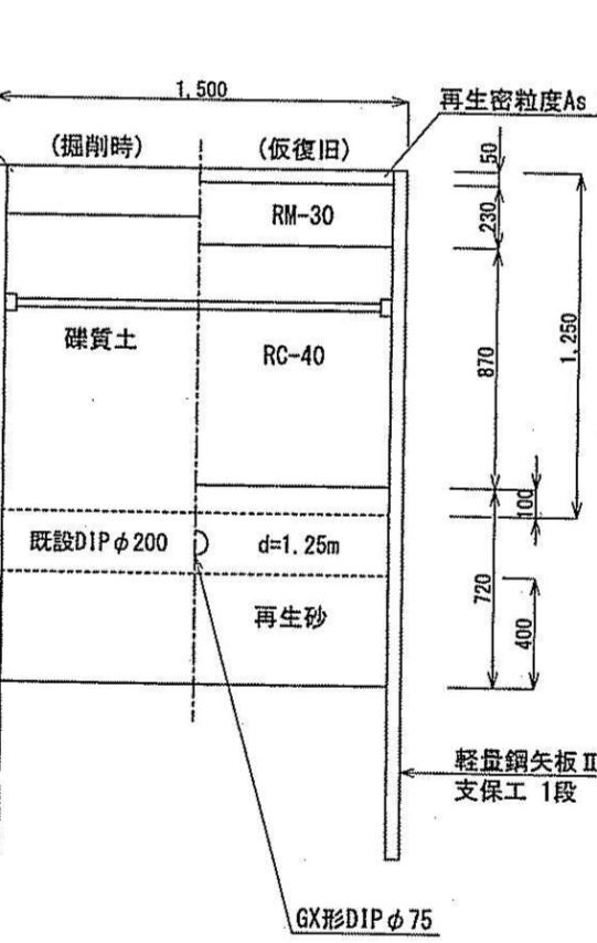
DIP φ200 (d=1.25m) 不排水分岐部① (国道支道部) L=3.0m
