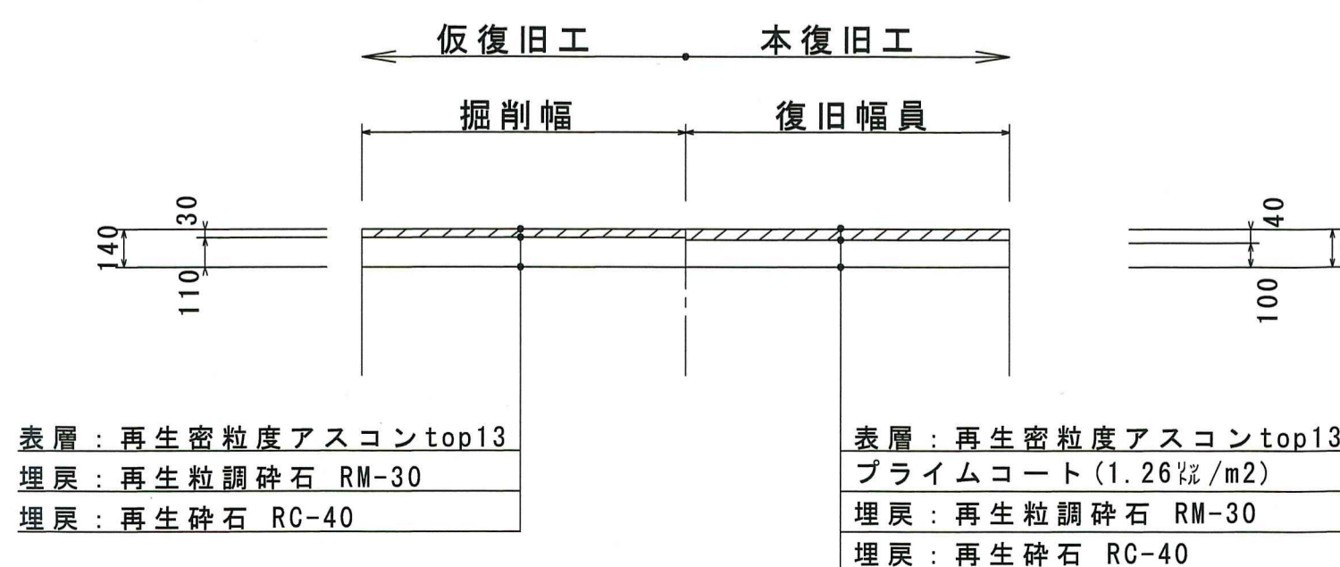
舗装構成図 S=1:25 (歩道部)
