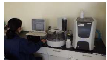
TOC（全有機炭素計測定法）
