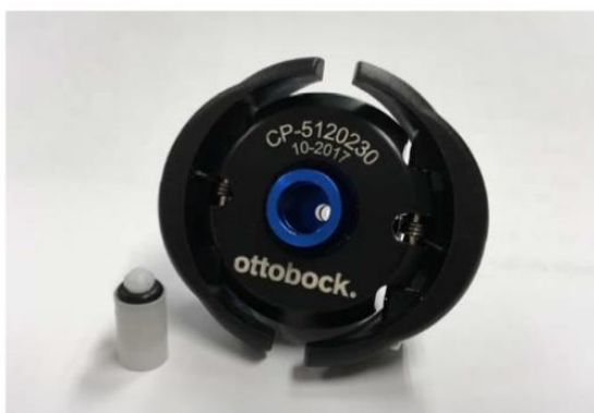
【該当バルブパーツが外れた状態】
